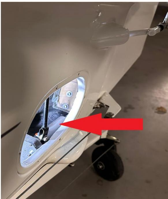
**1. Öffnen der Service Klappen unter dem Höhenleitwerk**
